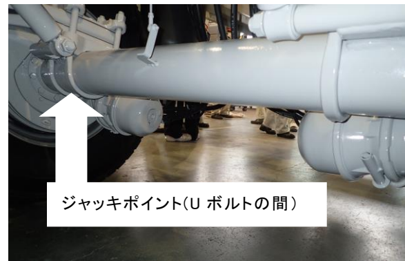
第6図. 車軸のジャッキアップ
